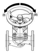
Obr. 3: Ruční kolo-otevřít (I), zavřít (0)
