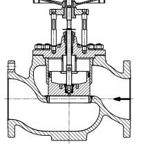
Obr.2: Směr proudění armaturou s tlakově odlehčenou kuželkou
