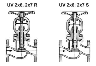
Obr.1: Směr proudění armaturou s talířovou nebo tvarovanou kuželkou
