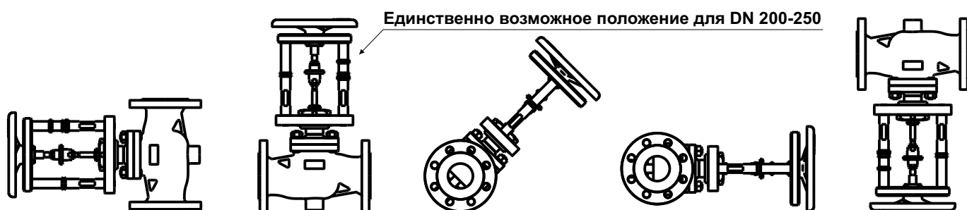
Монтажные положения клапанов с ручным штурвалом
