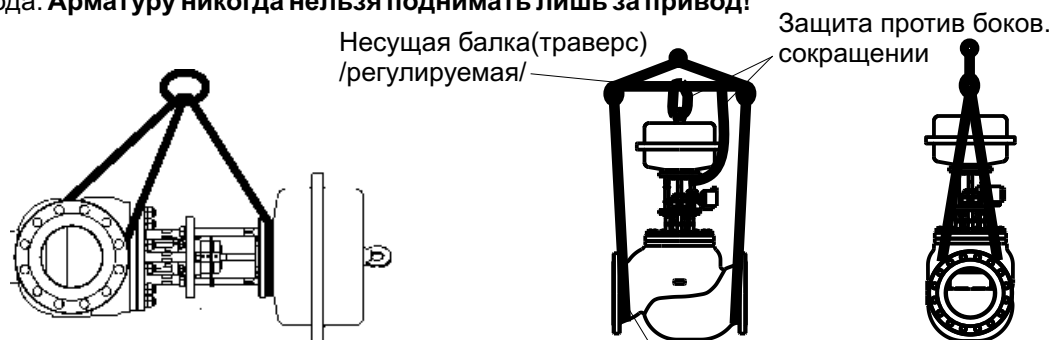
Рис. 10: Пример использования такелажных средств при манипулировании с устройством
