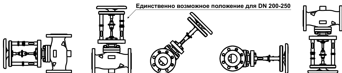
Рис. 2: Монтажные положения клапанов с ручным штурвалом
