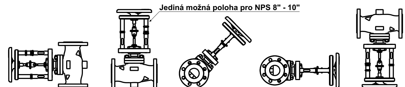
Montážní polohy ventilů s ručním kolem
