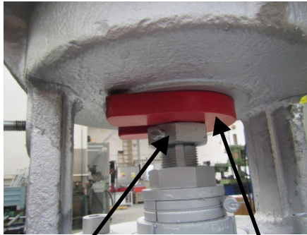
Блокированный ПК при испытании давлением
